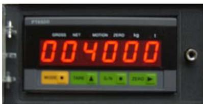
将重量等于该秤最大量程的标准砝码加在承载器上(假设此时为 40KG)，用 ZERO 键和 TARE 键，将显示器的读数设为所加砝码的重量，按 MODE 键完成称量间距调校过程。
