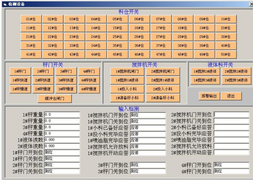
检查输入信号是否正常，使用鼠标点击设备的按钮，检查相应设备的动作是否正常；
