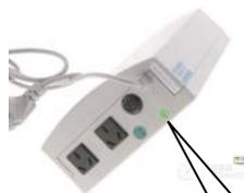
此插座专供电脑主机和显示器使用，以备在意外停电时发挥系统的急停功能，禁止接入其他用电设备。
