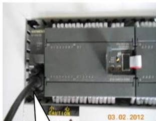
PPI 电缆连接到电脑串口
