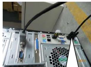
PPI 电缆连接到 PLC 串口
