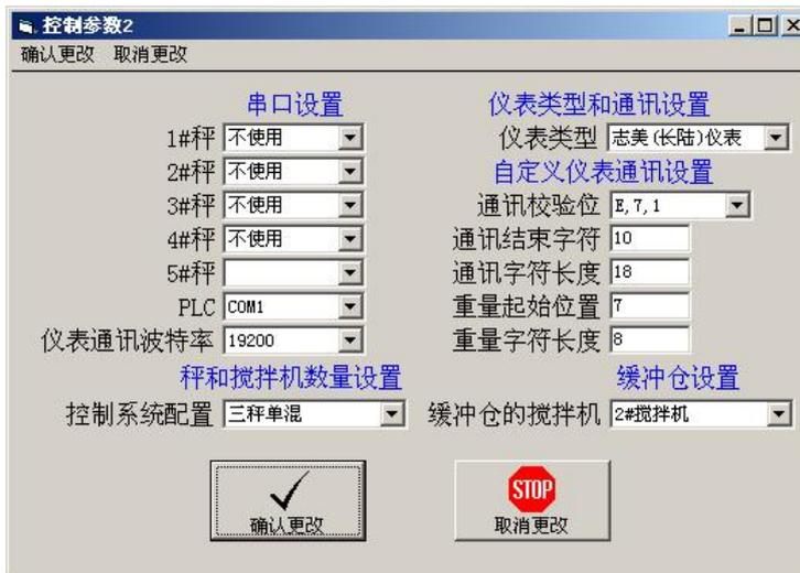
在“控制参数 2”界面中，可以设置秤和 PLC 串口、仪表类型、秤和搅拌机设置、缓冲仓的搅拌机等参数；这些参数必须根据设备实际情况设置，否则不能正常配料；
