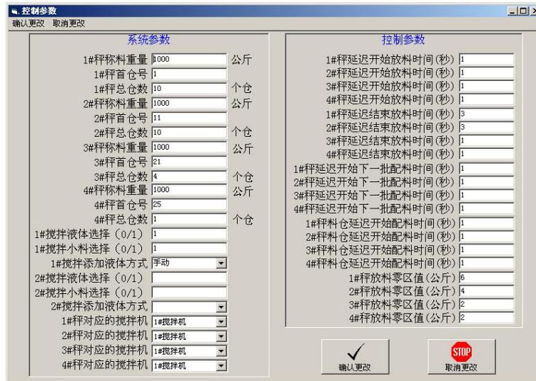
在“控制参数 1”界面中，可以设置秤称料重量、秤首仓号、秤总仓数、搅拌机液体选择、搅拌机小料选择、搅拌机液体添加方式、秤对应的搅拌机等系统参数和秤延迟开始放料时间、秤放料延时时间、秤延迟开始配下一批时间、料仓延迟开始配料时间、秤零区值等控制参数；
